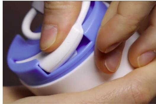
Danach drücken Sie den Rücken des Sensors fest. Zuletzt können Sie den Schwanenhals nachziehen. Ist der Sensor richtig eingelegt, leuchtet die Status LED zur Bestätigung kurz auf.
